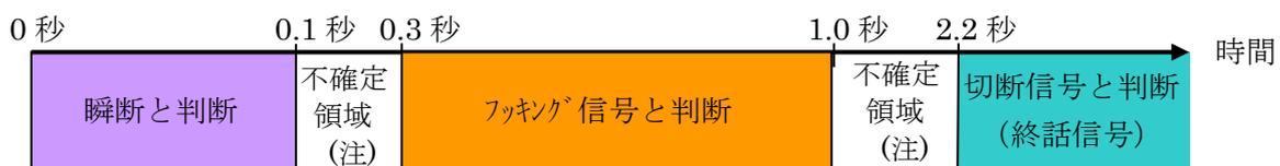
(注) 不確定領域内では、メタル収容装置の状態により瞬断とフッキング信号、フッキング信号と切断・終話信号との判断ポイントが変わります。
