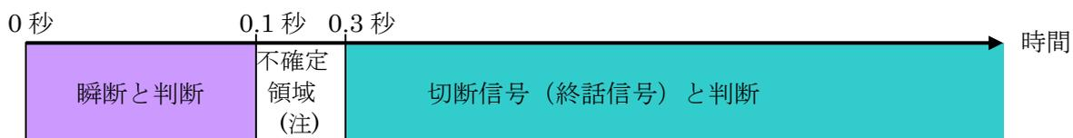
(注) 不確定領域内では、メタル収容装置の状態により瞬断と切断・終話信号との判断ポイントが変わります。
