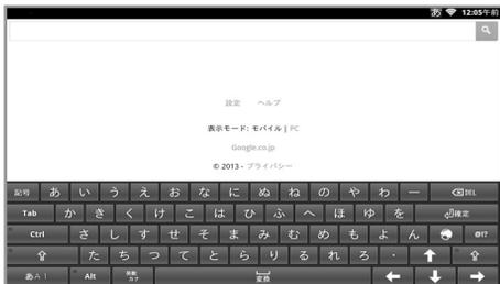
ソフトウェアキーボードの種類を切り替えるには、左下の「あA1」ボタンを選択して、「決定」ボタンを長押しします。メニューが表示されるので、「入力方法」を選択し、リモコンの「決定」ボタンを押します。
