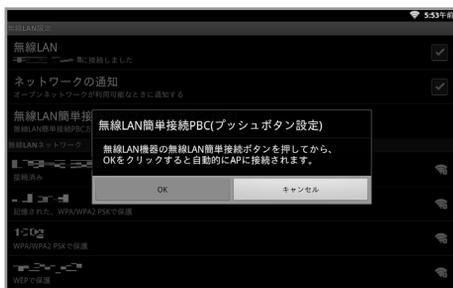
③ 無線LANアクセスポイントのLAN簡単接続ボタンを押してから、OKを選択し、リモコンの「決定」ボタンを押してください。
